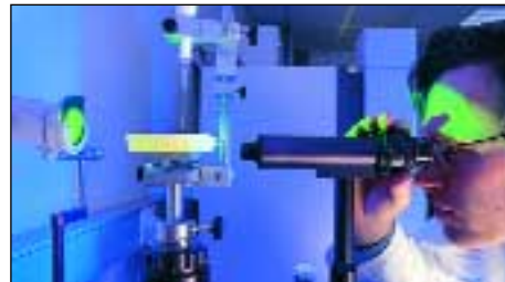
Messung des Kontaktwinkels zwischen Wasser und Wachs.
